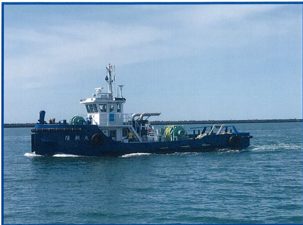
【 姿 写 真 】 曳船 鋼製 19t 1138PS×2基
