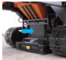
2 コンベヤテール部
